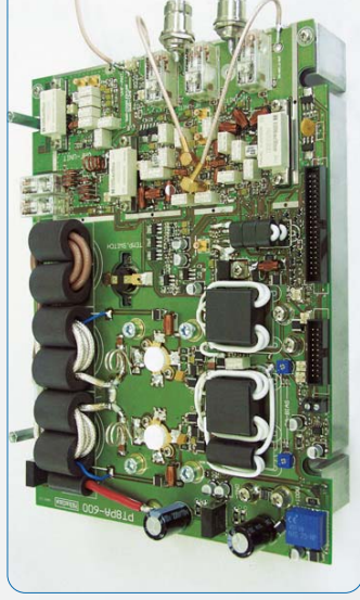
600 Watt PA mit 2-Feld-Effekt-Transistoren
